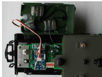
dreiadrige Kabel wird wie in unserem Beispiel an die drei entsprechenden Anschlüsse (+24V GND und A5) auf dem Decoder angelötet.
