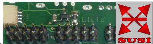
Platine mit Ausgang für SUSI und Eingängen für 29 Taster. Mit dieser Platine lassen sich SUSI Komponenten auch ohne Decoder oder Computer testen und betreiben. Betriebsspannung 12 - 24 Volt Gleich- oder Wechselspannung.
