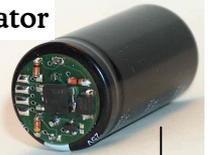
Kondensator mit Ladeelektronik zum Anschluss an diverse Lokdecoder.
