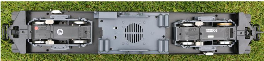
zeichnet. Nachdem alle Schrauben gelöst wurden, wird als erstes der Lautsprecher auf dem bereits vorhandenen Durchbruch mittels vier Schrauben aus der Bastelkiste montiert. Nun können die beiden Anschlusskabel (braun und weiß) des eMOTION S Sounddecoders auf den zwei Lötnägeln am bereits eingebauten Digitaldecoder gesteckt werden.
