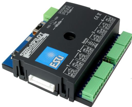
Mit dem SwitchPilot V2.0 stellen wir Ihnen die zweite, verbesserte Version unseres bewährten Zubehördecoders vor. Er ist ein robuster Multiprotokoll Schalt- und Weichendecoder zum Schalten von bis zu 4 doppelspanuligen Magnetartikeln (z.B. Weichen) oder 8 Verbrauchern wie Entkupplungsgleisen oder Glühbirnen (z.B. Weichen- Straßen- oder Hausbeleuchtungen). Durch seine intelligente Software kann er unter DCC oder Motorola® eingesetzt werden.
