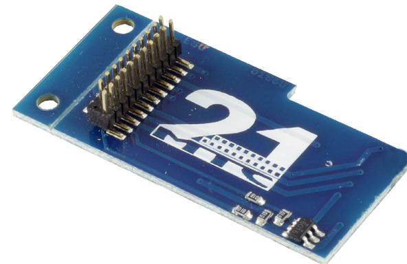
Die 21MTC Adapterplatine 2 eignet sich, wenn Sie eine Lok ohne Schnittstelle digitalisieren möchten, aber den Decoder nicht frei verdrahten wollen oder mehr als 4 Funktionsausgänge an Ihrem LokPilot oder LokSound Decoder nutzen möchten.
