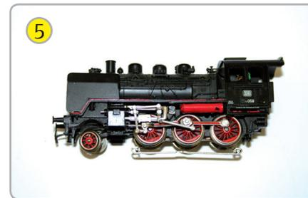
Zum Abschluss das Gehäuse wieder auf die Lok aufbringen und darauf achten, dass keine Leitungen eingeklemmt werden.
