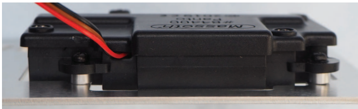
Abbildung 1: Montage des Antriebs auf der Montageplatte. Gut erkennbar ist die Lage der Distanzhülsen
