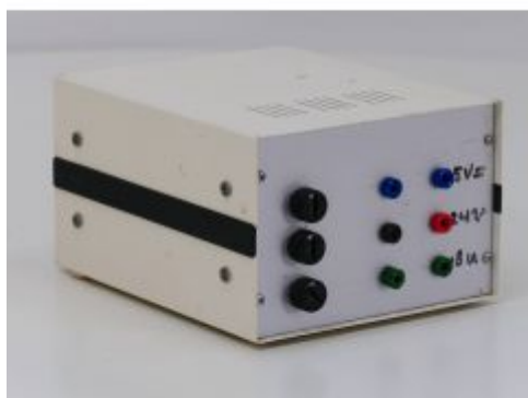
Trafo 5, 18 en 24 Volt 3x 3 Ampere
