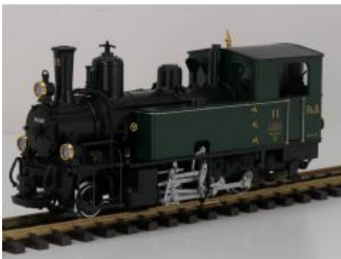
LGB 20272 RhB Dampflok G 3/4 11 Heidi, Sound, Digitaal, Gepulster Dampf, Energie Speicher, Metall Griffen
