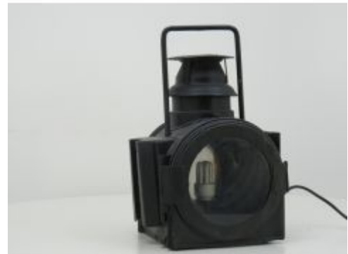
DB Flugelsignal Lampe, 220V Umbau
